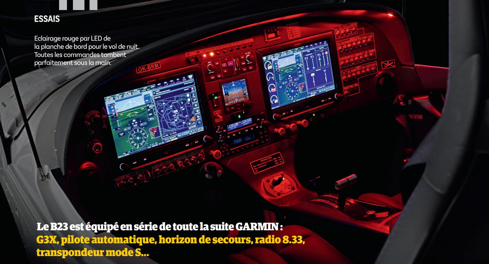
**Le B23 est équipé en série de toute la suite GARMIN : G3X, pilote automatique, horizon de secours, radio 8.33, transpondeur mode S...**
