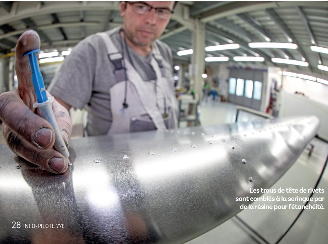
Les trous de tête de rivets sont comblés à la seringue par de la résine pour l'étanchéité.
